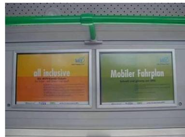
Bei der Anbringung der Klapprahmen ist darauf zu achten, dass weder die Verschlüsse der Dachrandklappen verdeckt noch die Funktionalität der Klappen eingeschränkt wird.
