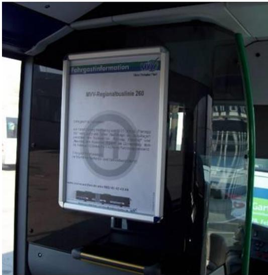
Darüber hinaus ist ein Klapprahmen (DIN A2) zur Aufnahme von **MVV-Plakaten** an der Rückseite der Fahrerkabine anzubringen und jeweils ausschließlich und durchgehend mit Informationen und Hinweisen des MVV bzw. des Aufgabenträgers zu bestücken (←).
